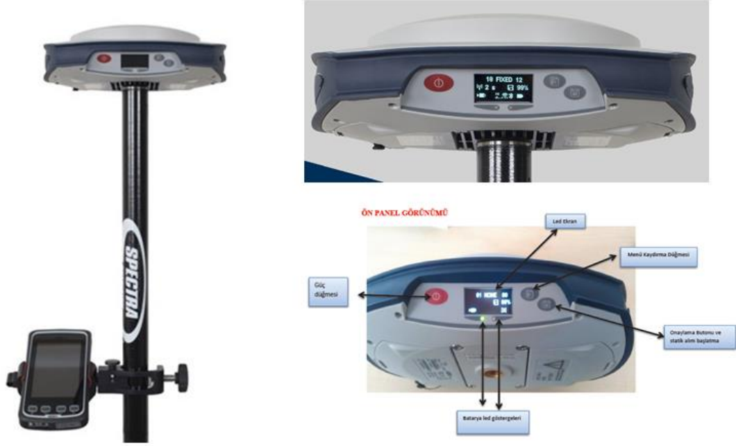
Şekil 3. 27. Spectra Precision SP80 marka GNSS alıcı cihazı (URL-37)
