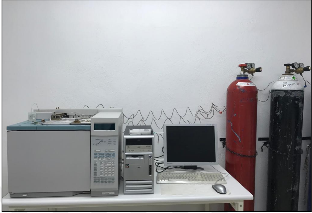
Şekil 3.11. Denemede kullanılan solunum hızı ölçüm cihazı (Gaz kromatografisi)
