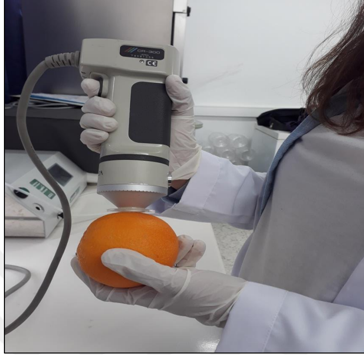
Şekil 3.9. Meyve kabuk renginin belirlenmesinde kullanılan renk ölçüm cihazı
