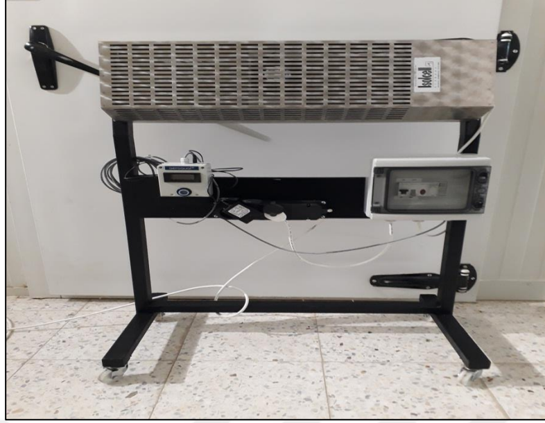
Şekil 3.5. Sürekli ozon uygulamasında kullanılan ozon jeneratöründen görünüm
