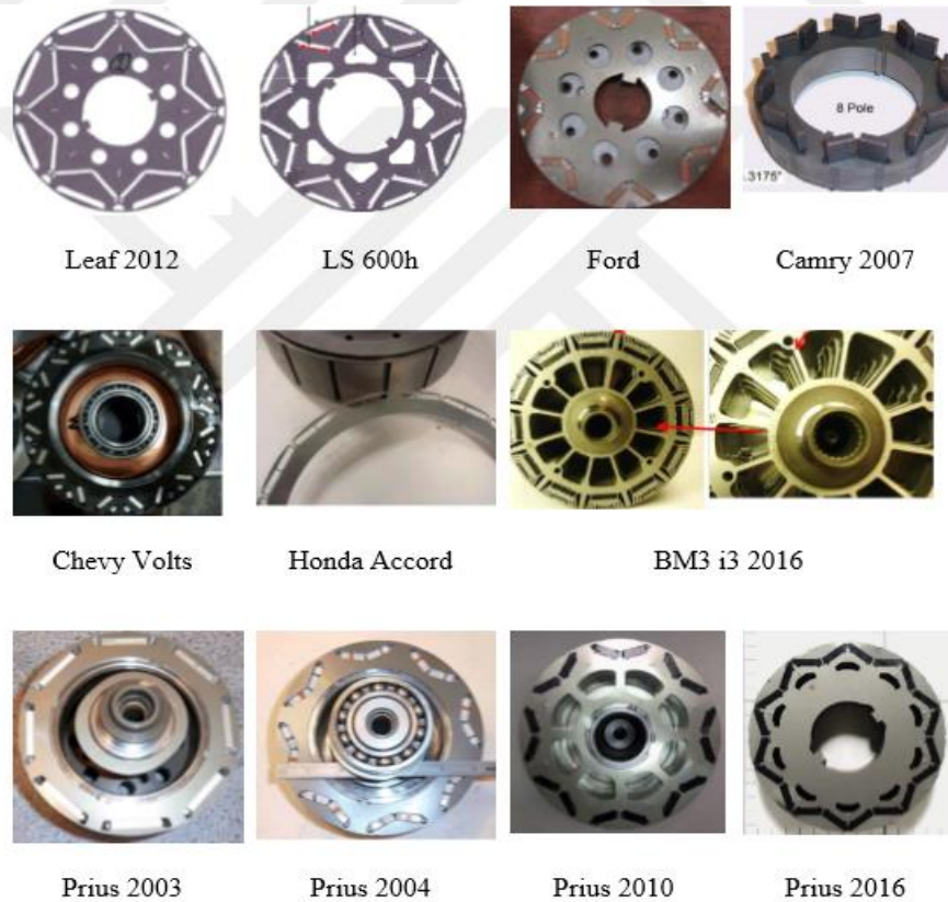
Şekil 3.3. Marka, model ve yıllara göre elektrikli araçlarda kullanılan rotor laminasyonları [32]
