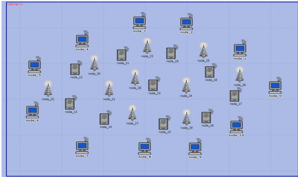
Şekil 4.26. Ortam deęişkenlięi testi 10 adet kablosuz sunucu ve 10 adet telekom vericisi i ortam konumlandırması
