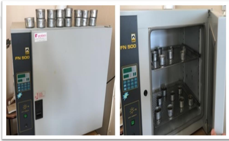
Şekil 3.18. Etüv ile toprak nemi belirlenmesi
