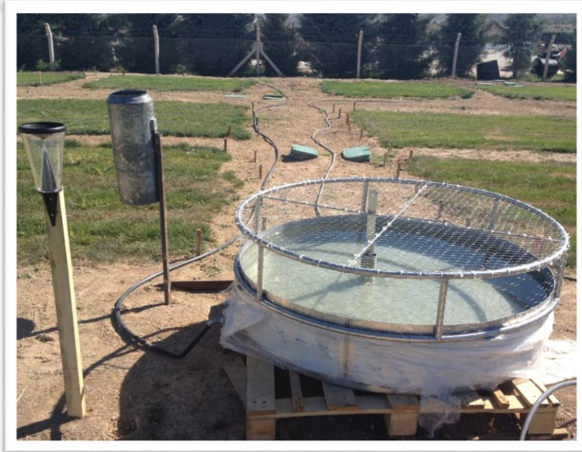
Şekil 3.9. A sınıfı buharlaşma havuzu ve plüviyometre.
