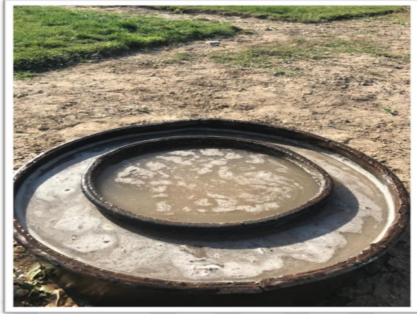
Şekil 3.17. Toprağın su alma hızı ölçümü
