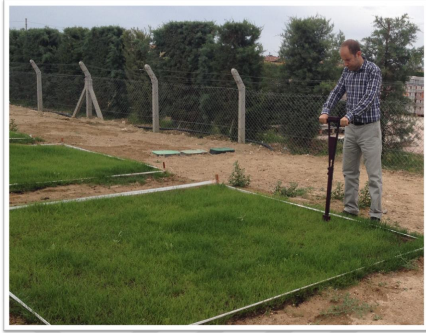
Şekil 3.8. TDR 300 toprak nemi ölçme cihazı ile nem takibi
