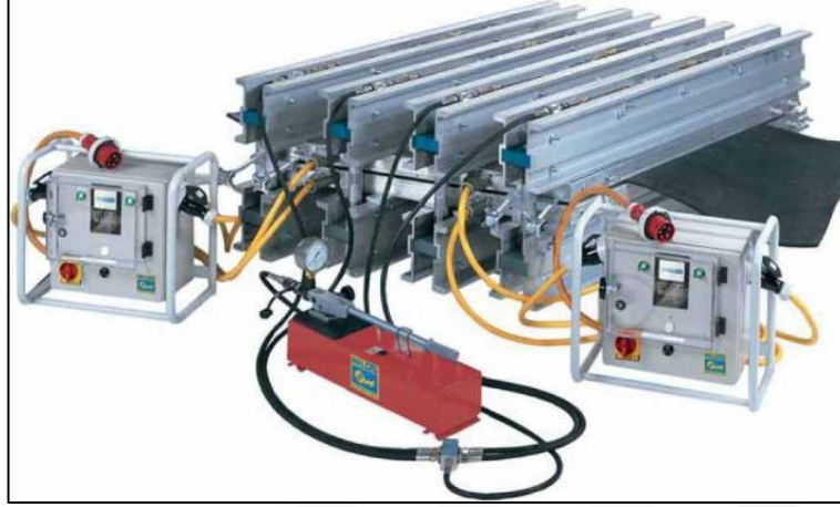
Şekil 3.5. Vulkanizasyon kaynak makinesi [26].
