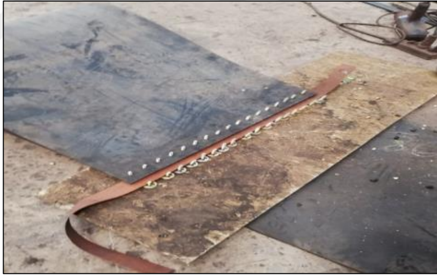
Şekil 3.36. Raptiye arası bez monte edilmesi.
