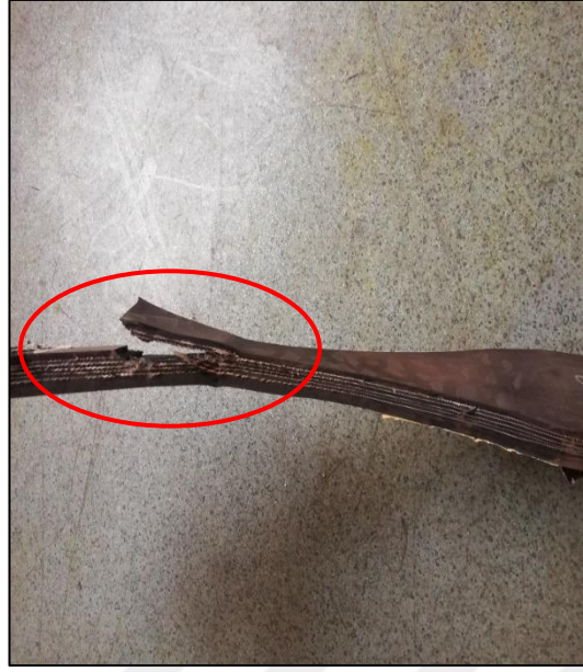
Şekil 6.3. Vulkanizasyon yöntemiyle birleştirilmiş bant çekme deneyi kopması.
