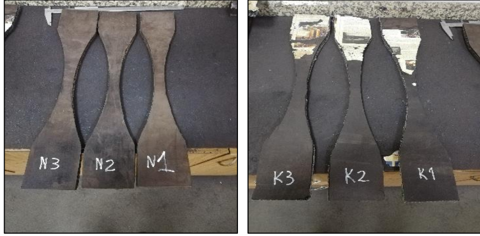
Şekil 5.6. Papyon şeklindeki normal (N) ve vulkanize (K) bant numuneleri.
