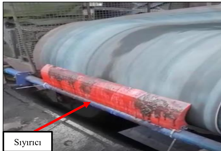
Şekil 2.9. Sıyırıcı (temizleyici, silici).
