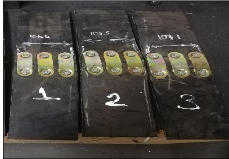
Şekil 5.7. Mekanik ek bağlantılı bant numuneleri.
