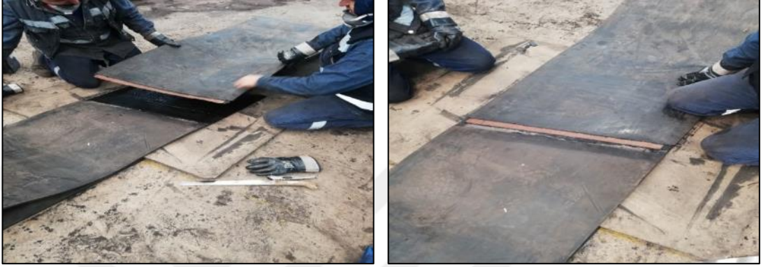
Şekil 3.24. Bant kapama işlemi.
