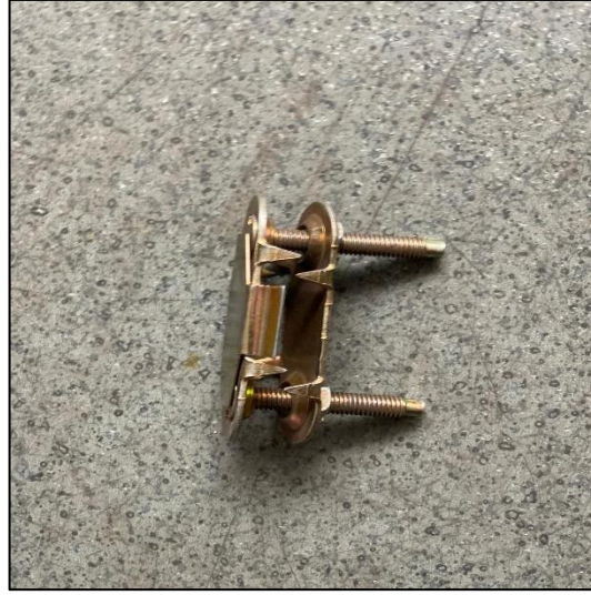
Şekil 3.32. Tesiste kullanılan bant raptiyeleri.
