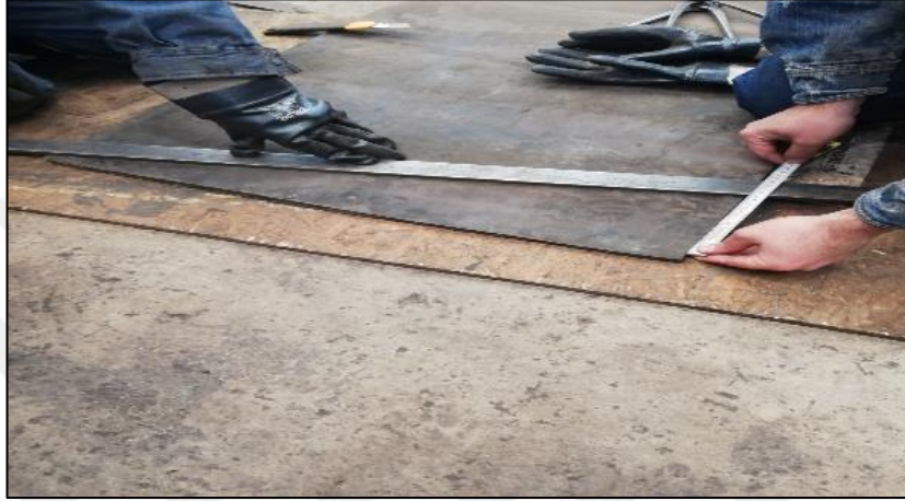
Şekil 3.12. Bant ek yeri markalama ve kesim işlemi.
