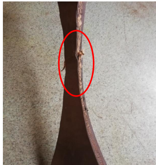
Şekil 6.1. Nomal, işlemsiz bant bant çekme deneyi kopması.
