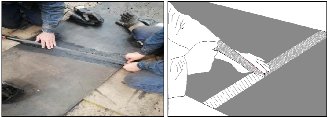
Şekil 3.25. Üst kapama kauçuğunun yapıştırılması.
