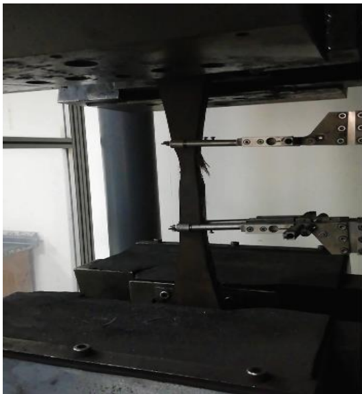
Şekil 6.1. Nomal, işlemsiz bant bant çekme deneyi kopması.
