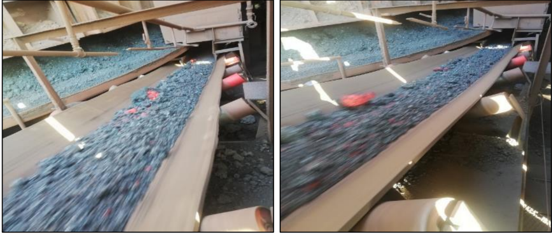
Şekil 2.21. Tesiste kullanılan T tipi ısıya dayanıklı bant.
