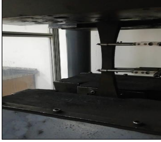
Şekil 5.9. Nomal bant ve vulkanizasyon yöntemi uygulanan bant çekme deneyi.
