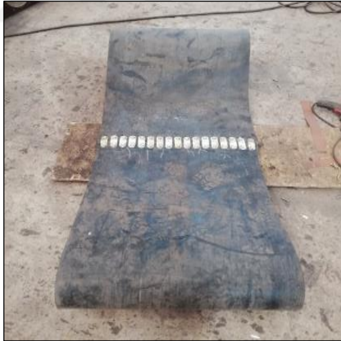
Şekil 3.38. Mekanik birleştirme yöntemi uygulanan bant.
