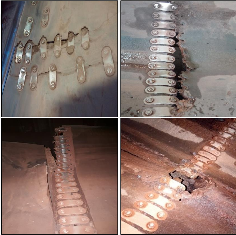
Şekil 3.2. Mekanik ek yeri hataları.
