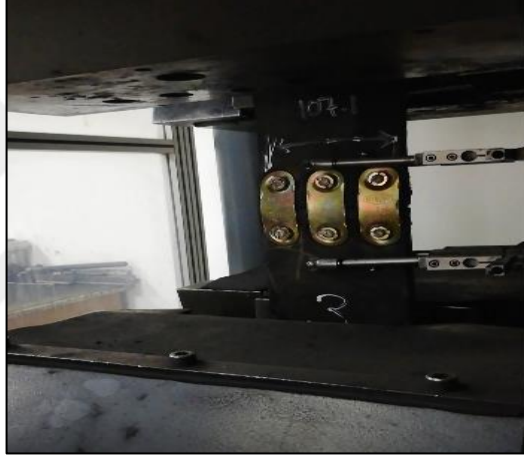
Şekil 5.10. Mekanik birleştirme yöntemi uygulanan bant çekme deneyi.
