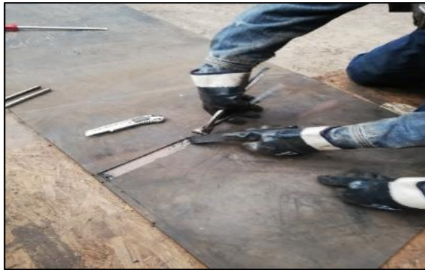
Şekil 3.13. Bant üst ekleme kauçuk kapağının kesilme işlemi.
