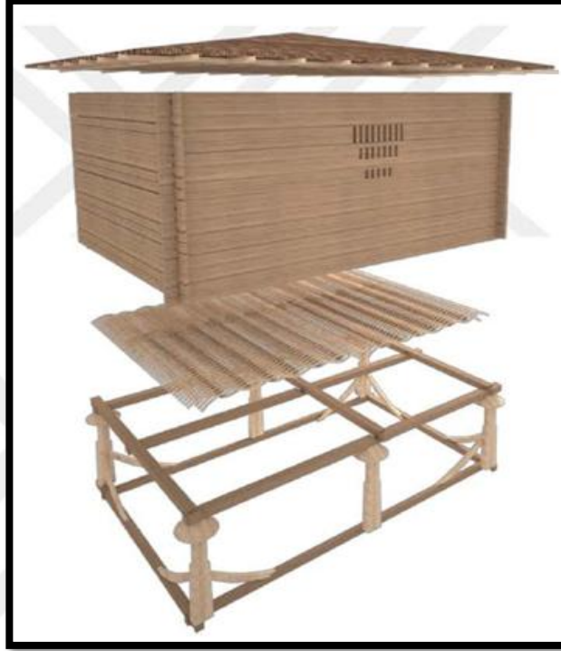
Şekil 16. Serenderleri Oluşturan Katmanlar (Yeşilyurt Tunç, 2017)
