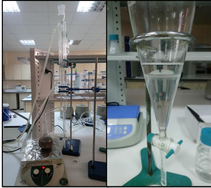
Şekil 3.5: Clevenger tipi aparatla uçucu yağların ekstraksiyonu (a), Sıvı-sıvı ekstraksiyon (b).
