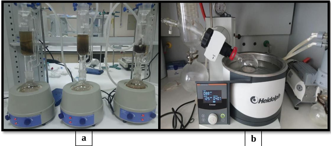
Şekil 3.4: Soxhlet cihazında ekstraksiyon (a) ve Rotary Evaporatör de evaporasyon (b).
