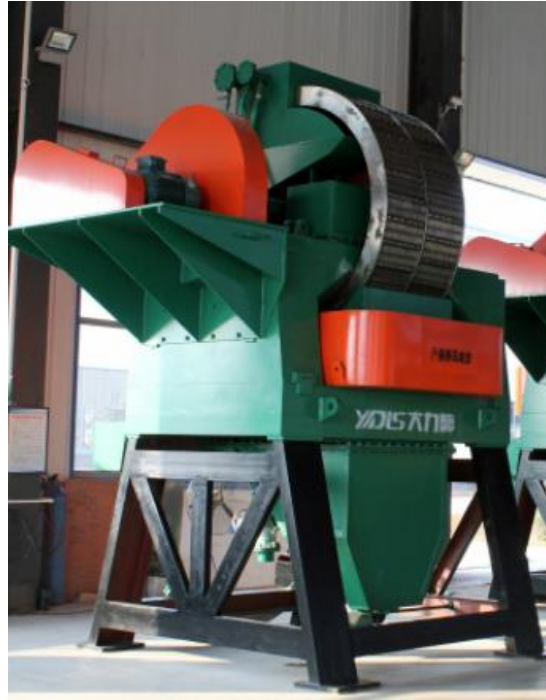
Şekil 1.26. Slon manyetik ayırıcısı
