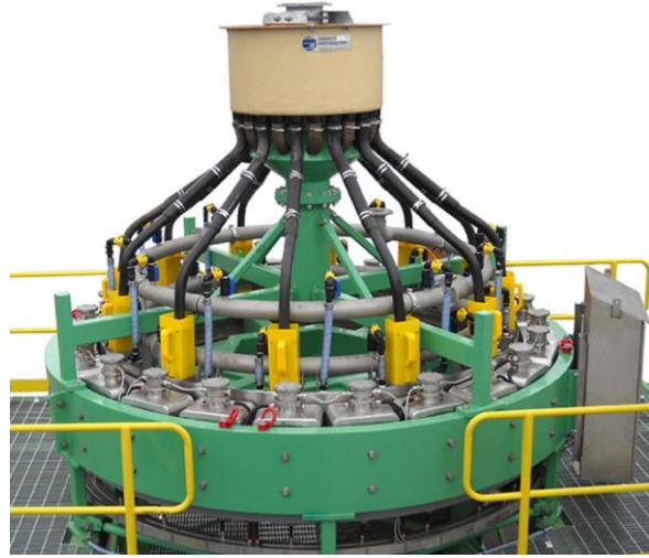
Şekil 1.23. Roche WHIMS manyetik ayırıcısı
