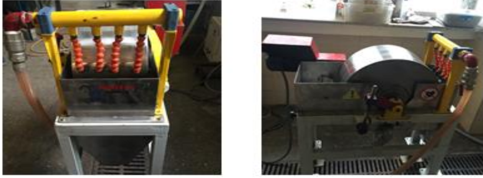
Şekil 1.11. Tambur tipi manyetik ayırıcı (pilot ölçek)
