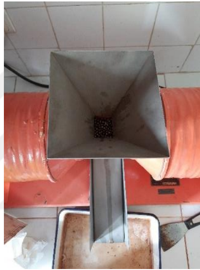
Şekil 2.11 Carpco yaş manyetik ayırıcısının üstten görünümü.
