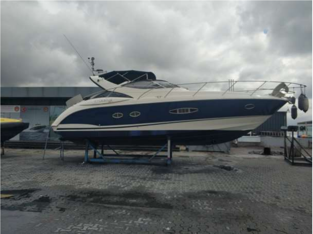
Şekil 2.26. Bakım için karaya çekilen fiberglas motoryat
