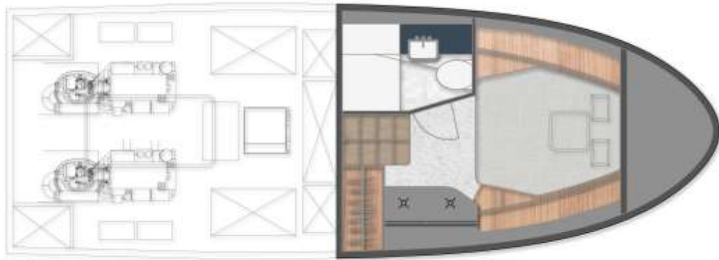
Şekil 4.4. 11 metre "Marlin" motoryatının alt güverte planı
