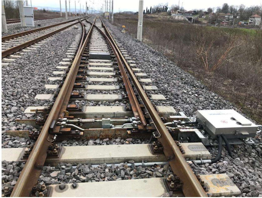
Şekil 2.1 : Makas ve makas motoru.
