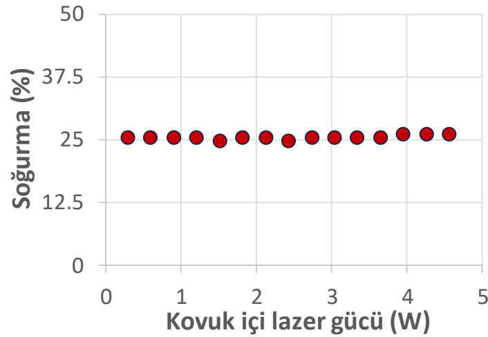
Şekil 5.8 : 2.36 W sabit pompa giriş gücünde \text{Tm}^{3+}:\text{KY}_3\text{F}_{10} kristalinin kavite içi lazer gücüne bağlı olarak ölçülen 1064 nm'de soğurma yüzdesi.
