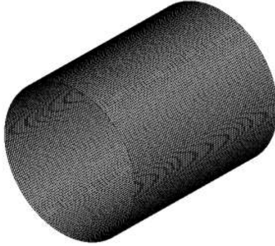
Şekil 23. Mükemmel (kusursuz) model ağ görünümü (7,5 mm)
