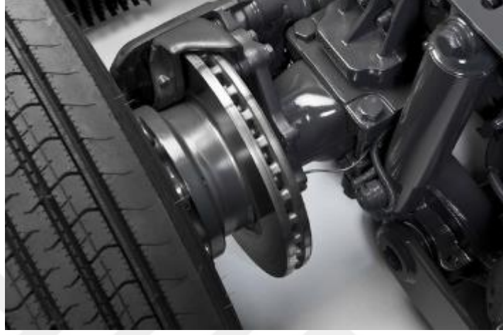
Şekil 2.2 Ağır Yük Kamyonlarında Diskli Fren Sistemi
