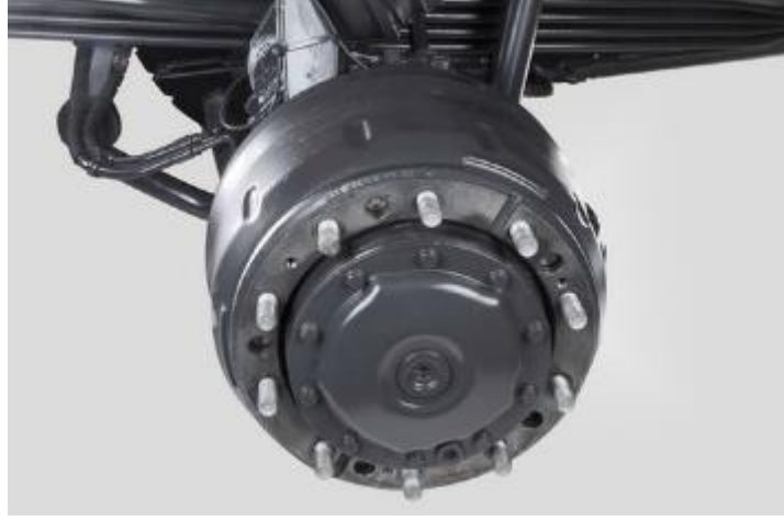
Şekil 2.3 Ağır Yük Kamyonlarında Kampanalı Fren Sistemi
