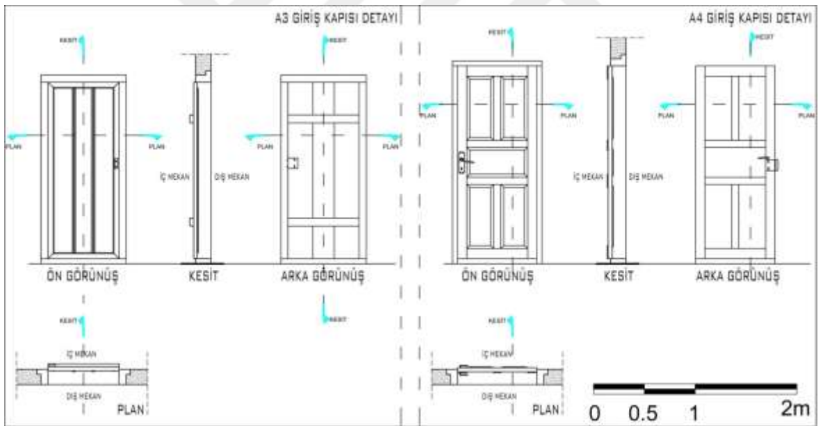
Şekil 5.12. Bağ evlerinde giriş kapısı detayları
