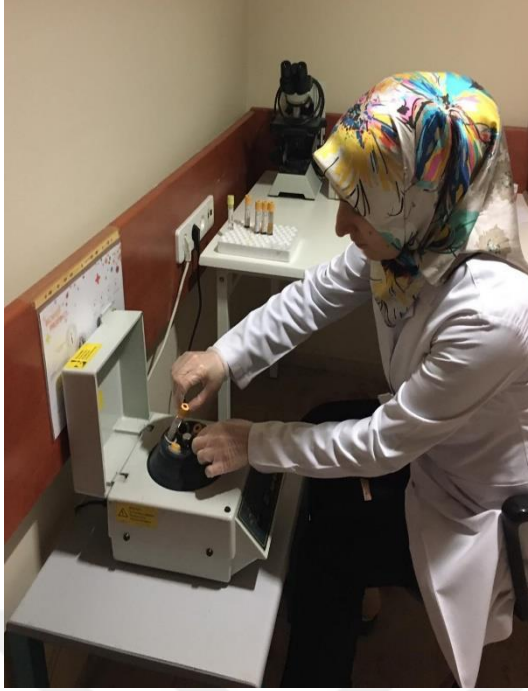
Resim 3.3 Nüve® NF615 marka santrifüj cihazı ile kanların serumlarına ayrılması
