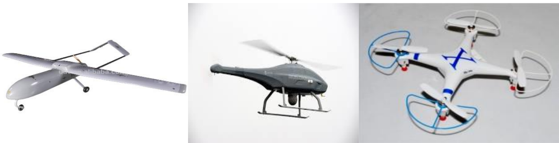
Şekil 3.2 Sabit kanatlı, döner kanatlı ve multikopter İHA örnekleri
