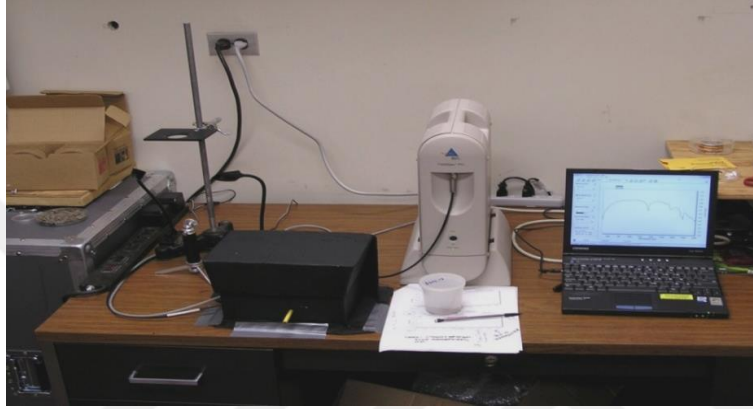
Şekil 3.5. Laboratuvar ortamında NIRS ve dedektör mekanizması
