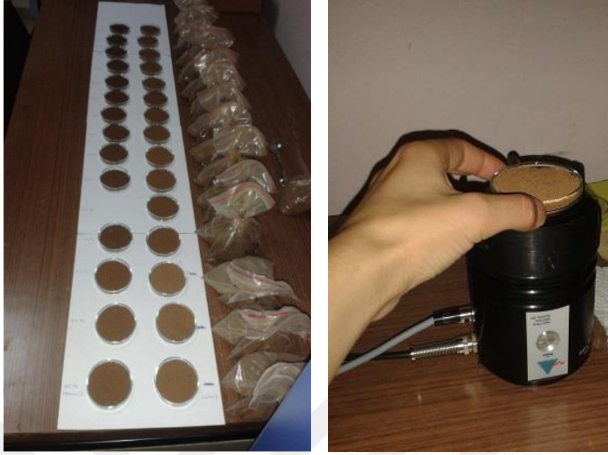
Şekil 3.6. Toprak örneklerinin (doğrudan elenmiş ve öğütülmüş) ışık kaynağı ile kontrol işleminin gerçekleştirilmesi
