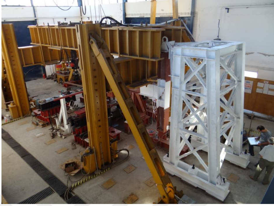
Şekil 4.14 : Mevcut (sarı) ve yeni (beyaz) reaksiyon çerçeveleri.
