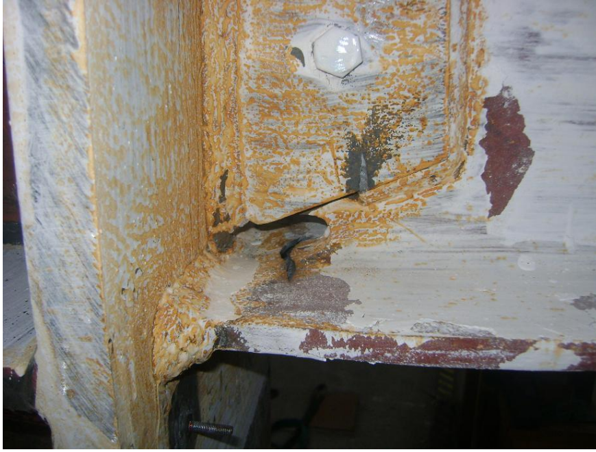
Şekil 4.27 : Test 4 numunesi deney sonu altbaşlık civarı yakın görünüşü.
