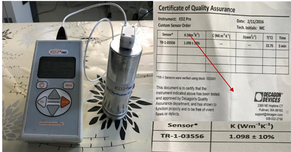
Şekil 3.1 KD2-Pro cihazının doğrulanması
