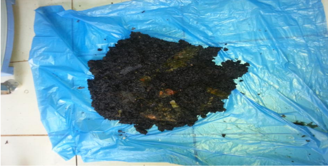
Şekil 4.47 Kuru fermentasyonda parçacık boyutu etkisinin araştırılmasında iki numaralı kuru fermentörden alınan nihai ürün
