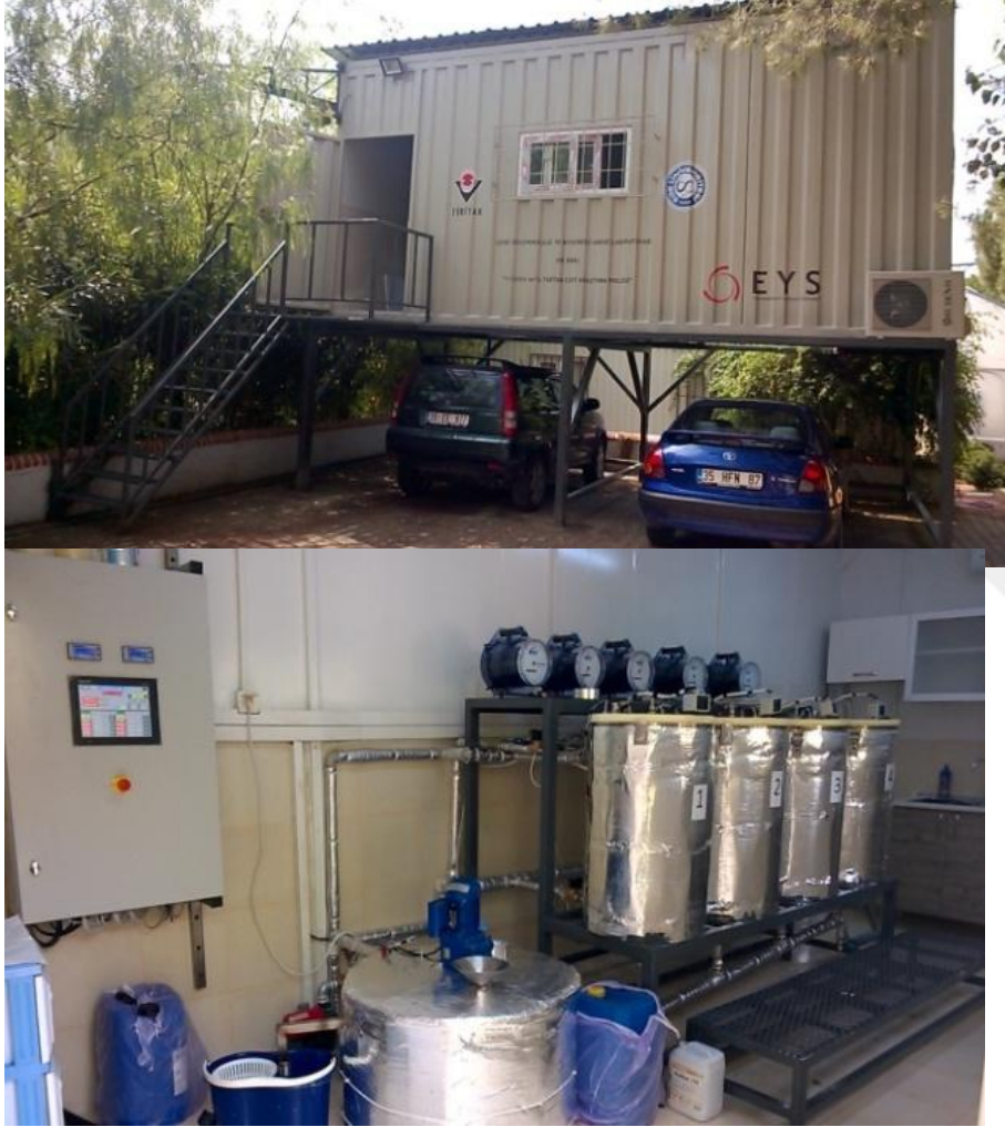
Şekil 3.1 Kuru fermentasyon reaktör düzeneğinin iç ve dış görünüşleri
