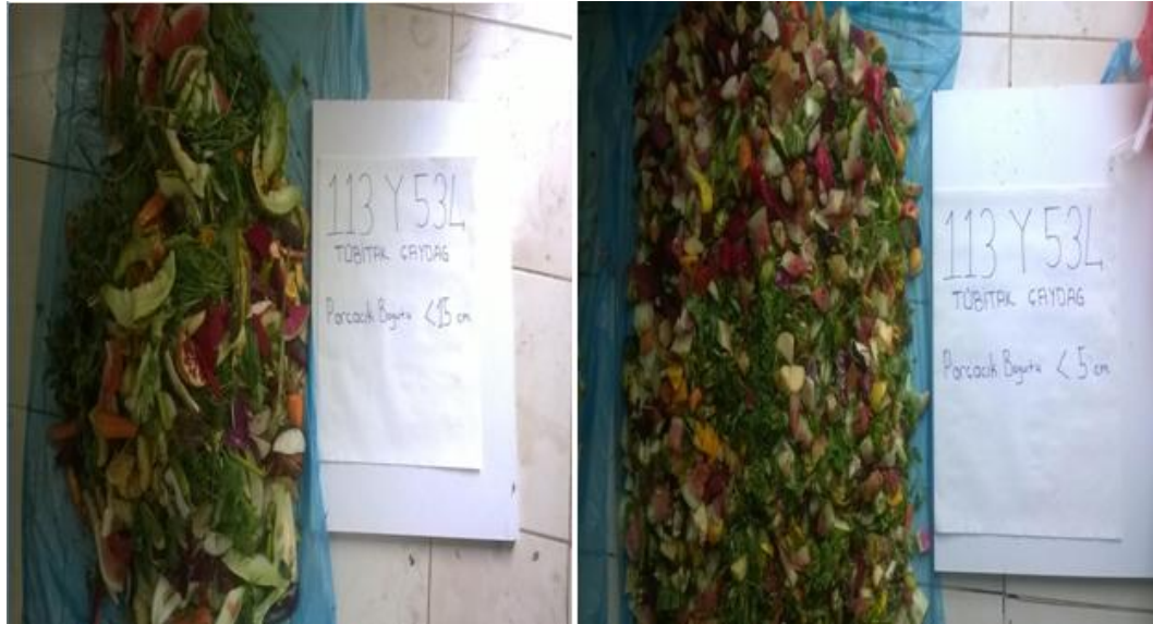
Şekil 4.41 Kuru fermantasyonda parçacık boyutu etkisinin araştırılmasında kullanılan KKAOF parçacık boyutları
