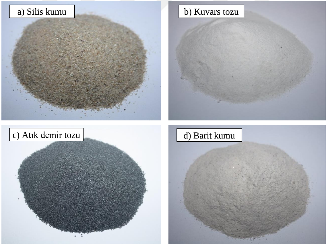
Şekil 3.3 UHPC üretimde kullanılan agregaların fotoğrafları
