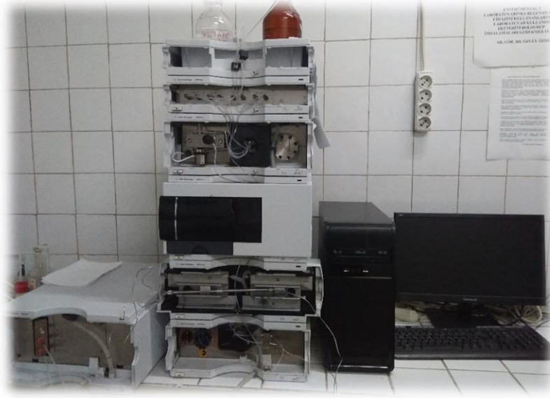
Şekil 3.16: Agilent 1200 (ABD) marka HPLC cihazı
