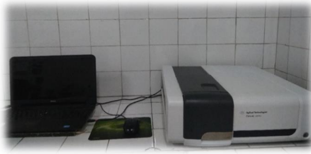
Şekil 3.17 : Agilent Technologies Cary 60 UV-VIS Spektrofotometre
