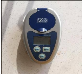
Şekil 3.13: Analizlerde Kullanılan Refraktometre (Krüss (Almanya))
