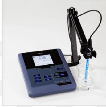
Şekil 3.14: Inolab marka pH level 7110 model (Almanya) pHmetre
