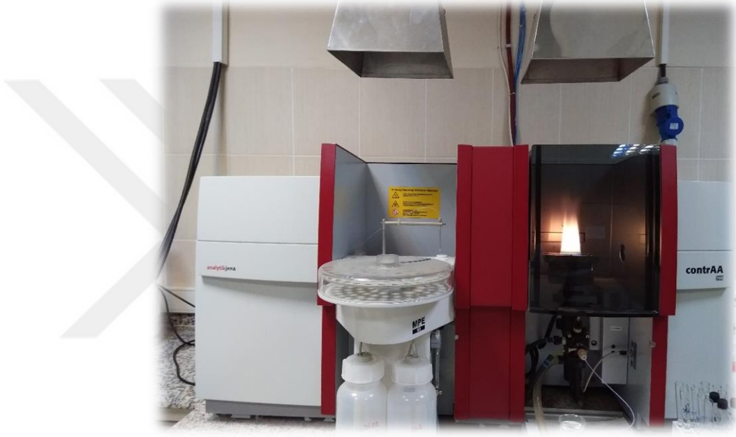
Şekil 3.18: Analytik Jena ContrAA 700 model alev emisyon atomik absorpsiyon spektroskopisi(AAS)
