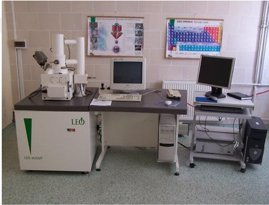
Resim 3.10 LEO 1430VP markalı taramalı elektron mikroskobu.
