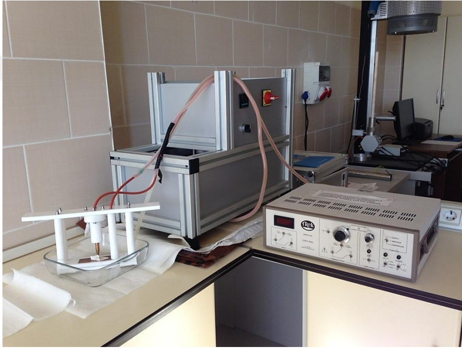
Resim 3.6 Trek 610E-K-CE marka kutuplama cihazı ve yağ banyosu.
