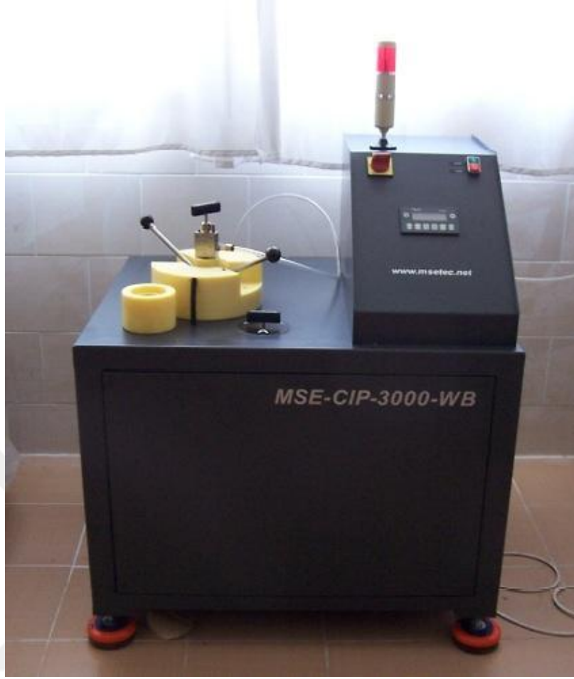
Resim 3.4 MSE-CIP-3000-WB markalı soğuk izostatik pres.
