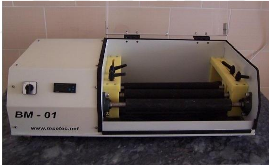
Resim 3.1 MSE-BM/01 markalı bilyeli yatay değirmen.
