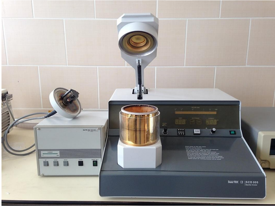
Resim 3.5 Baltec Sputtering SCD/005 markalı kaplama cihazı.
