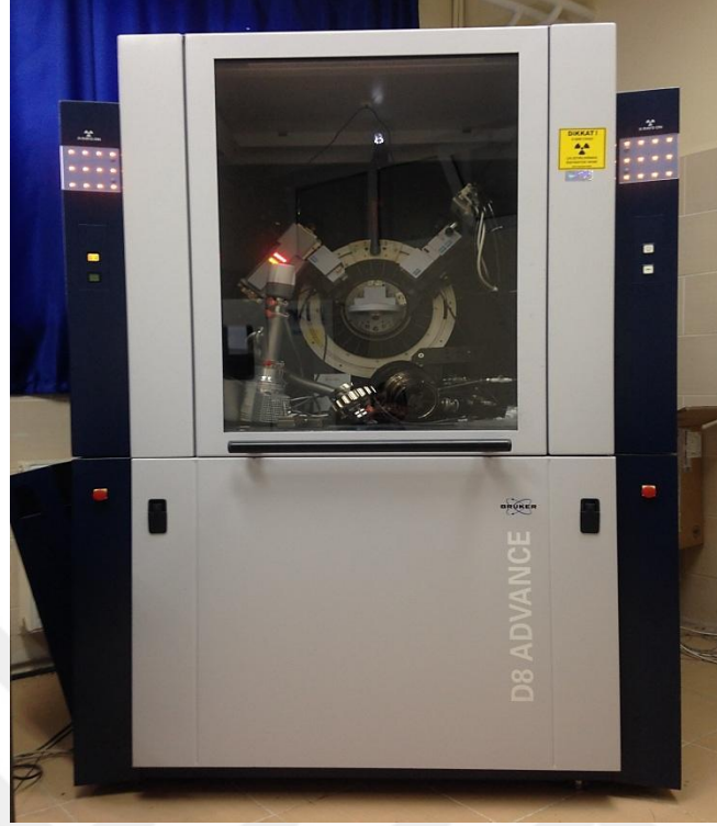
Resim 3.7 Bruker D8 Advance marka x-ışınları kırınım cihazı.
