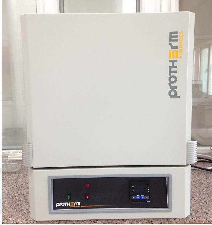
Resim 3.3 Protherm-PLF 130/12 markalı fırın.
