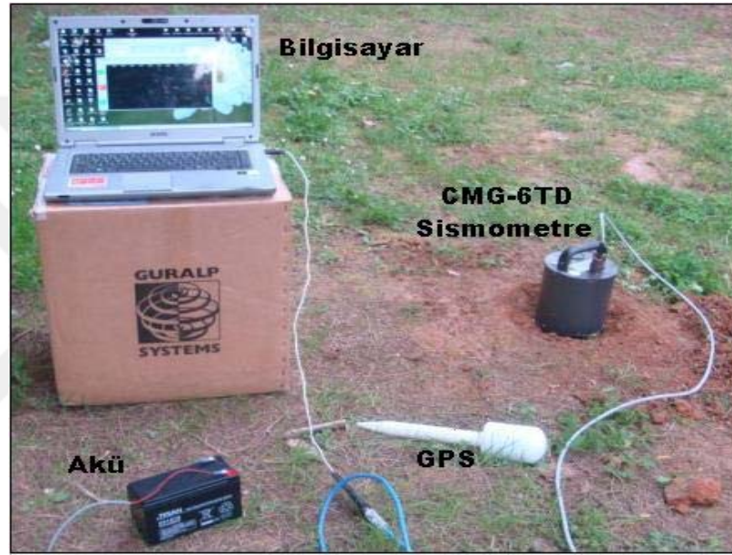
Şekil 3.23. CMG-6TD tipi geniş band sismometresi ile mikrotremor kaydı için gerekli olan cihazlar(Beker, 2013'den alınmıştır.)
