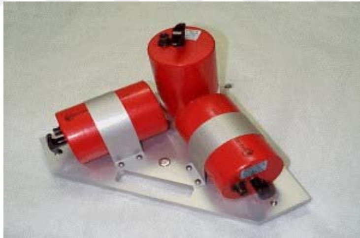
řekil 3.31. Mikrotremor ölçümleri için kullanılan geniş band aralıklı üç bileřenli sismometre (www.jeosist.com, 2011)
