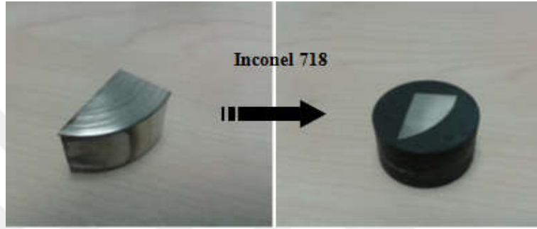
Şekil 3.8. Inconel 718 malzemenin bakalite alınması.
