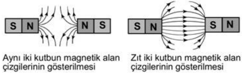
Şekil 3.13. Manyetik alan çizgilerinin gösterilmesi (MEGEP, 2011).
