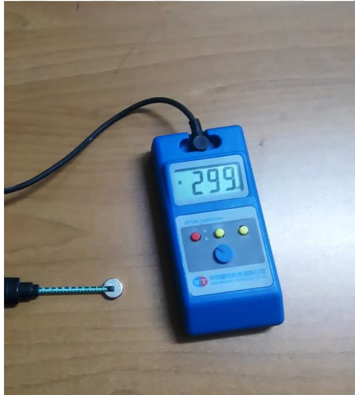
Şekil 7.4. Manyetik alan ölçüm testi.
