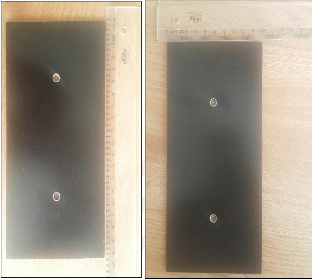
Resim 4.16. Darbe testinde kullanılan test numunesinin boyutları
