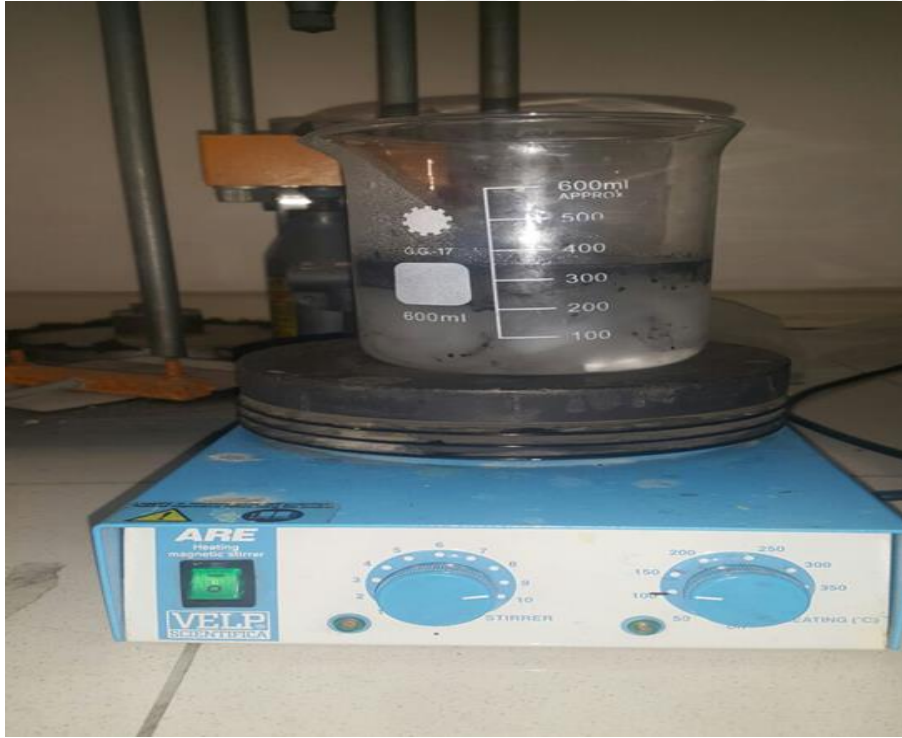
Resim 4.9. Manyetik karıştırıcıda nano grafen – epoksi karıştırılması
