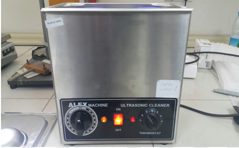
Resim 4.10. Ultra sonik cihazında grafen-epoksi karıştırılması
