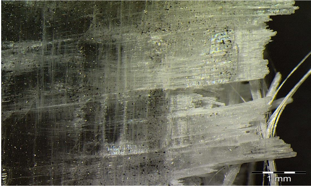
Resim 5.4. Çekme deneyi sonrası NG25 numunesi kırık yüzeyi ön taraftan enine kesit yönde a) makro görüntüsü b) optik mikroskop görüntüsü
