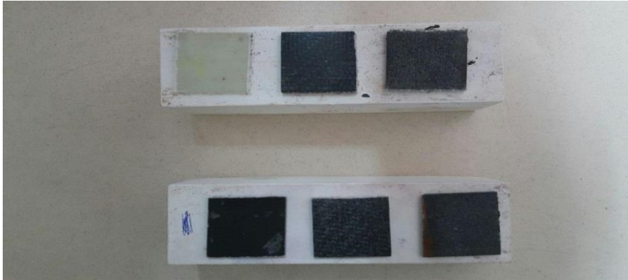
Resim 4.25. Fırına koymadan önce hazırlanan yakma deney numuneler
