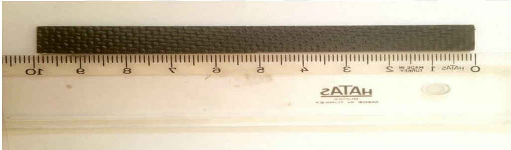
Resim 4.12. Üç nokta eğme test numunesinin boyu
