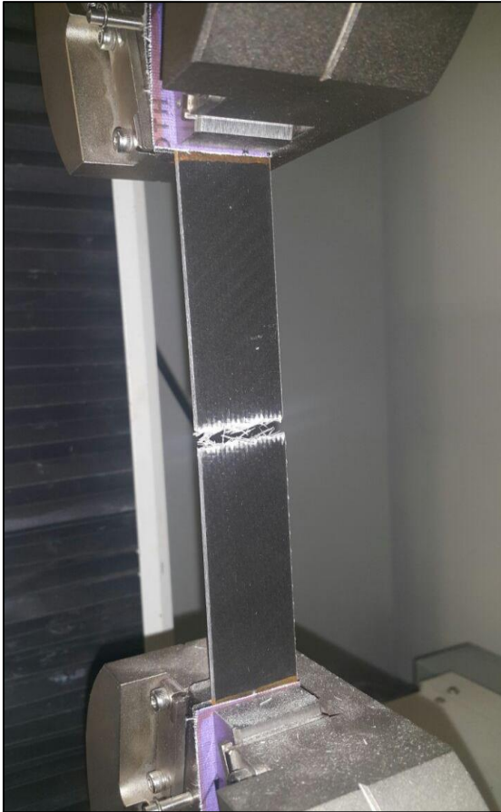
Resim 4.15. Çekme deneyi esnasında kırılan numune
