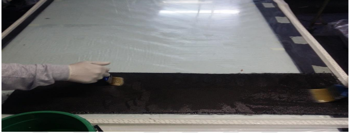
Resim 4.4. Ayırıcı film serilmiş cam panelin üzerinde serim işlemine başlanması
