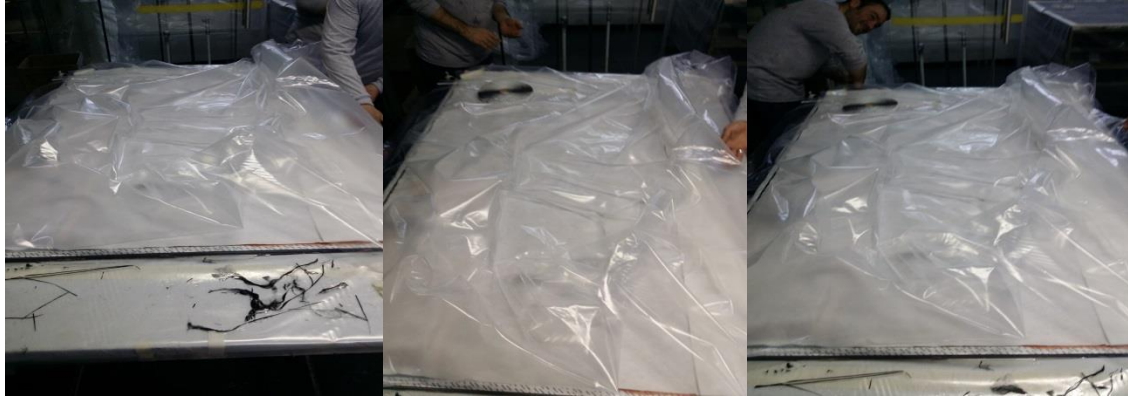
Resim 4.5. Vakum port, Ayırıcı film, Airweave ve Vakum paketi yerleştirilmiş panelin kenarlarının bantla çevrilmesi
