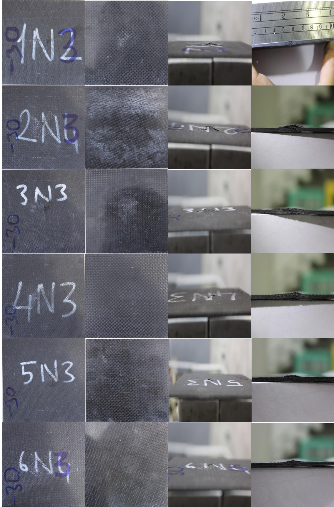
Resim 4.23. -30°C’de darbe uygulanmış numunelerin arka, ön, sol yan ve kesit alınmış yan görünüşü
