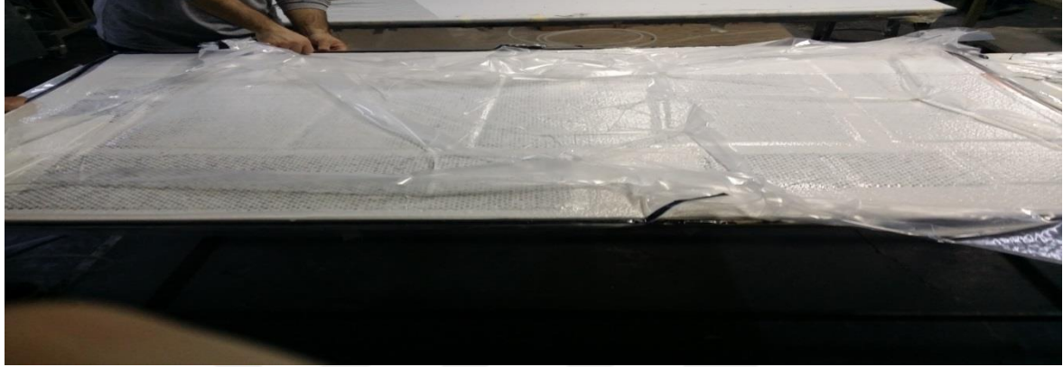
Resim 4.6. Hava çıkışını engellemek için kullanılan bantın yerleştirilmesi
