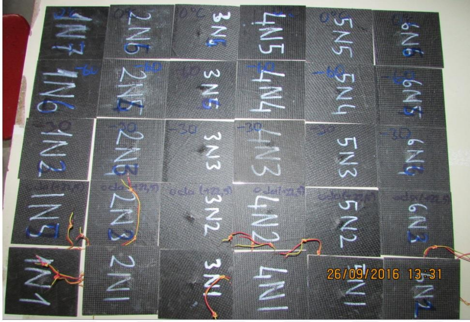
Resim 4.25. +22,5°C , +22,5°C (strain-gage), -30°C, -60°C ve 0°C darbe uygulanmış numuneler
