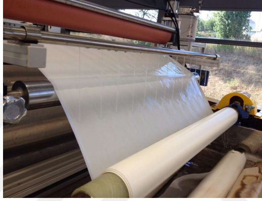
Şekil 3.2 : Pilot ölçekli membran dökme işleminin aşamaları.
