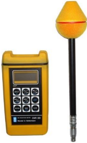
Şekil 3.4. Elektromanyetik alan ölçüm cihazı (NARDA EMR 300 cihazı ) ve probu
