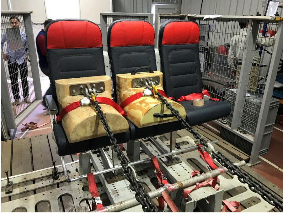
Görsel 2. 5 Prototip 'Spreader' parçaların, statik/dinamik testler esnasındaki görüntüleri.
