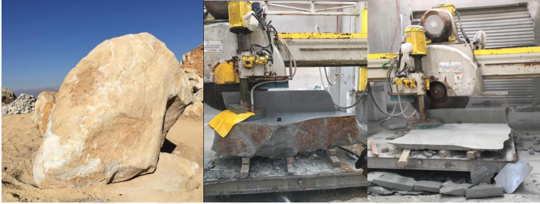
Şekil 3.5. Ocaktan çıkarılan, ST ile taraması yapılmakta olan foit monzosiyenit porfir bloğu ve pasaya atılacak olan blok altı
