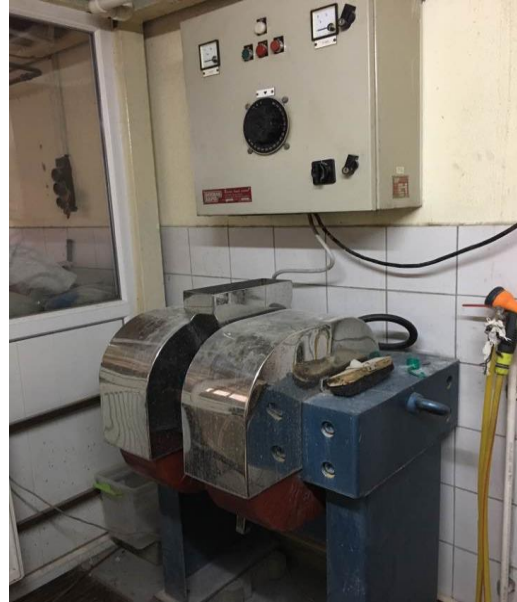
Şekil 3.11. Laboratuvar tipi yüksek alan şiddetli yaş manyetik ayırıcı
