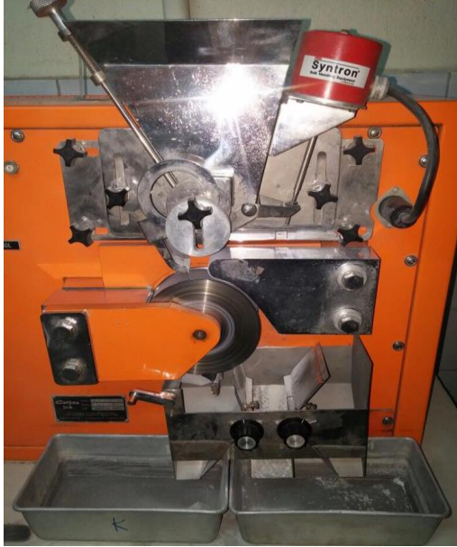
Şekil 3.10. Laboratuvar tipi yüksek alan şiddetli tamburlu kuru manyetik ayırıcı
