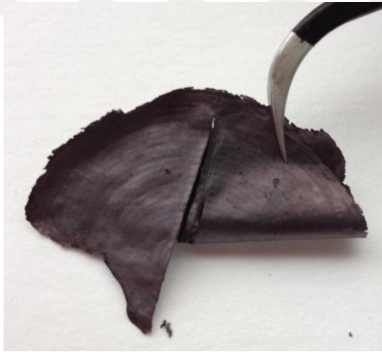
Şekil 4.9. 20 kat fazla oranda eklenen AgNPs süspansiyonu ile hazırlanan rGO/MB/AgNPs kompozit kağıdın fotoğrafı
