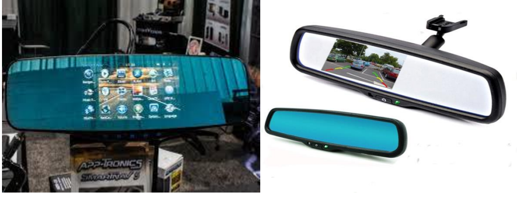
Şekil 2.2.1. Elektrokromik cihazların dikiz aynası olarak kullanımı
