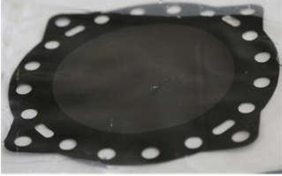
Fotoğraf 3.1. Deneyleerde kullanılan polimer elektrot membrana ait bir görüntü
