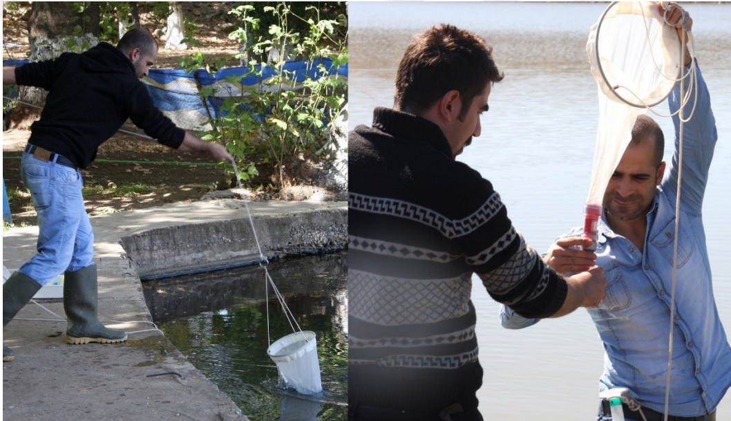
Şekil 3.4. Fitoplankton kepçesi ve kullanım yöntemi
