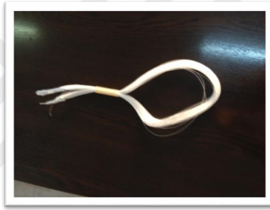
Şekil 3.2.AnMBR sisteminde kullanılan hollow fiber membran demeti
