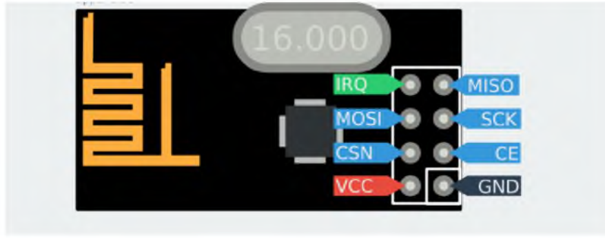
Şekil 4.16. nRF24L01 pin diyagramı
