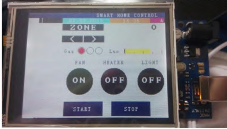
Şekil 4.23. Kontrol düğüm uygulama devresi
