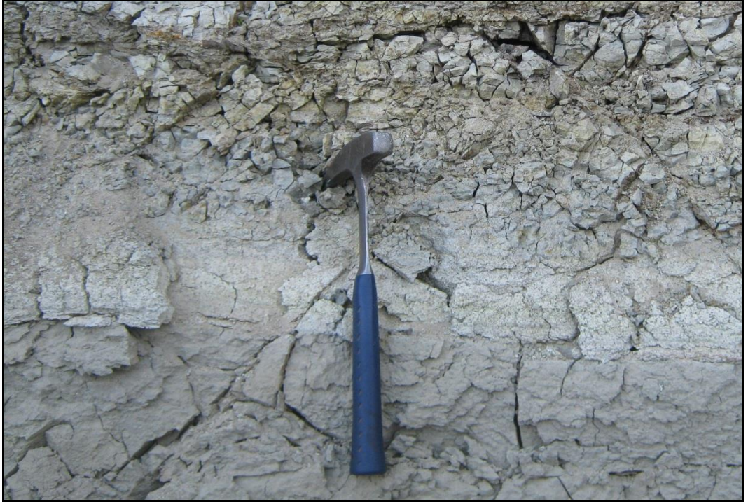
Şekil 4.44. İslambeyli Formasyonu'na ait kiltası ve silttaşları (Aydınlık Köyü doğusu)
