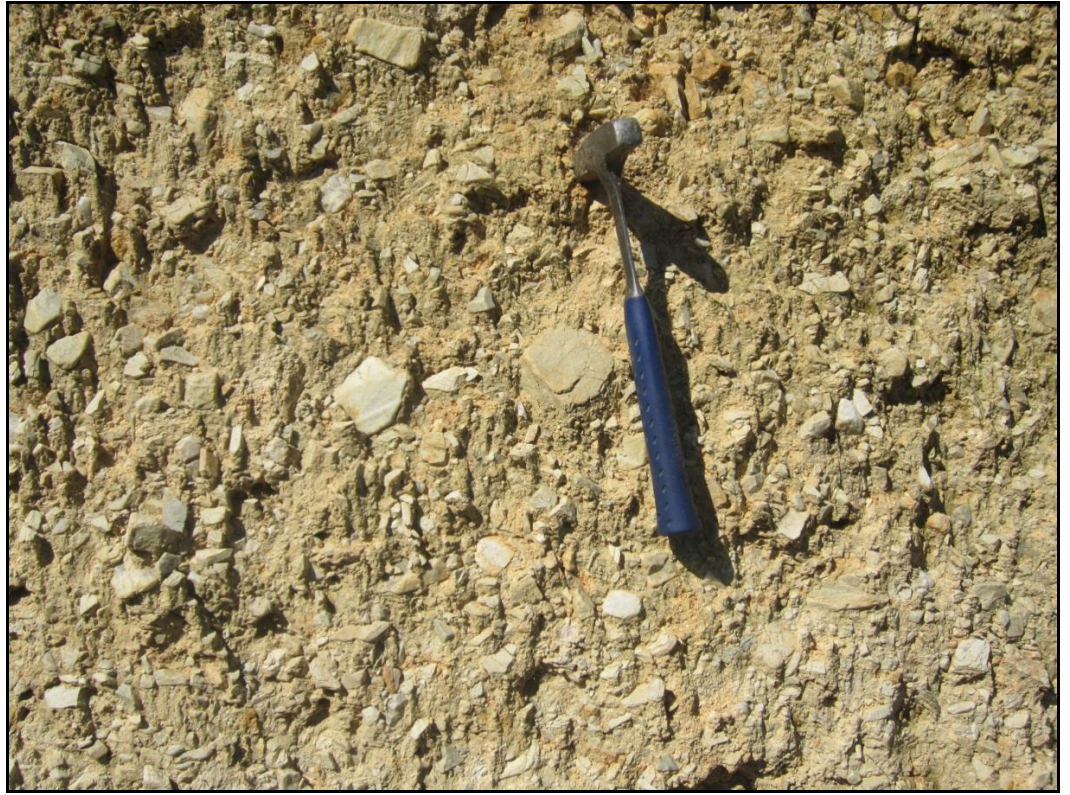
Şekil 4.66. Trakya Formasyonu kumlu, çakıllı seviyeler (Aydınlık Köyü kuzeydoğusu)
