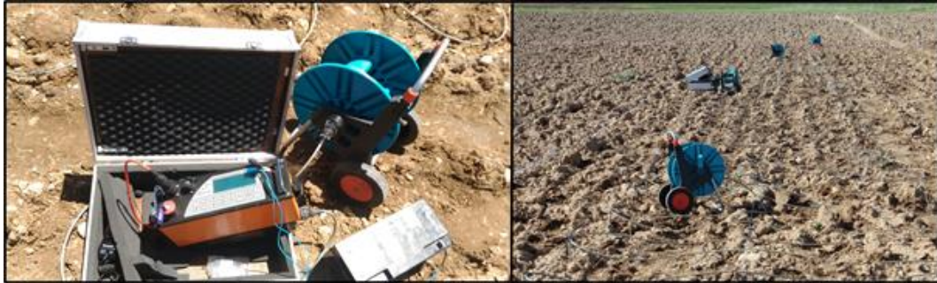
Şekil 4.3. Saha çalışmasında kullanılan GF Instruments 48 kanallı çok elektrotlu elektrik özdirenç sistemi
