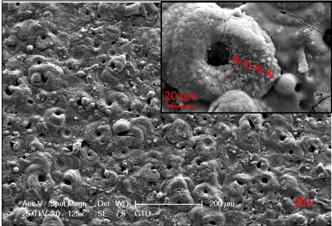
Şekil 5.63: E3 elektroliti içerisinde 120 dk kaplanmış Mg-2Al alaşımı üzerinde oluşan kaplamanın yüzey SEM görüntüsü ve SEM-EDS analizi yapılan noktalar.
