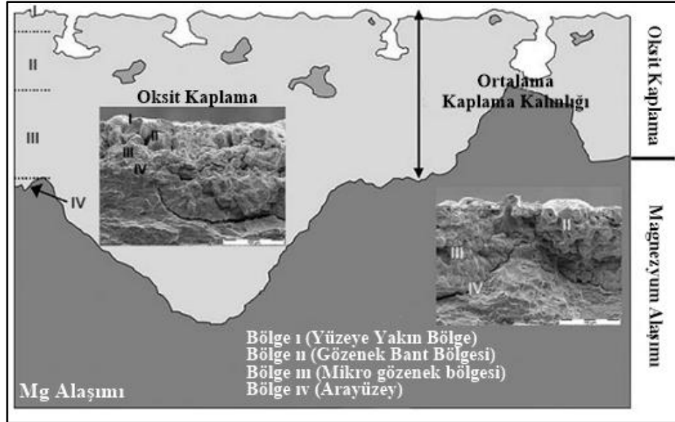
Şekil 3.5: Mg alaşımlarının PEO ile kaplanması sonucunda oluşan şematik kaplama ve kaplama içerisinde oluşan bölgelere ait SEM resimleri.
