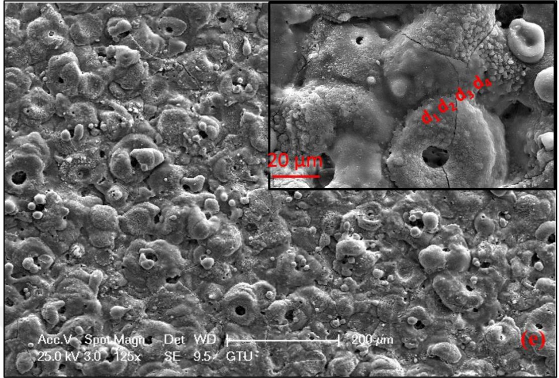
Şekil 5.66: E3 elektroliti içerisinde 120 dk kaplanmış Mg-2Zn alaşımı üzerinde oluşan kaplamanın yüzey SEM görüntüsü ve SEM-EDS analizi yapılan noktalar.
