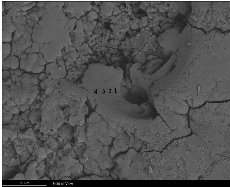
Şekil 5.21: E2 elektroliti içerisinde 20 dk kaplanmış saf Mg üzerinde oluşan kaplamanın yüzey SEM görüntüsü ve SEM-EDS analizi yapılan noktalar.
