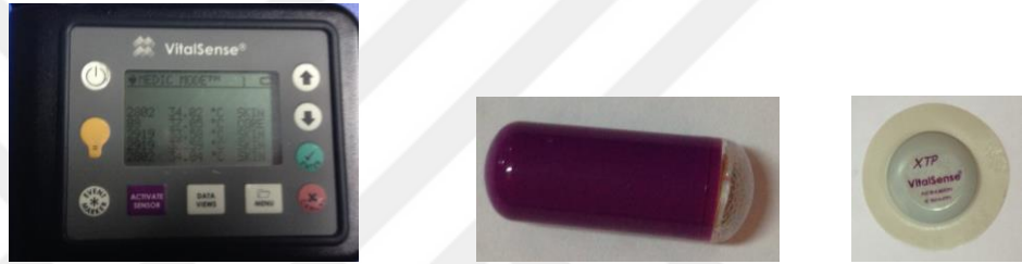
Şekil 5.15. Vital Sense test cihazı (a), Vücut iç sıcaklık ölçer kapsül (b), Deri yüzey sıcaklığını ölçen sensör (c).
