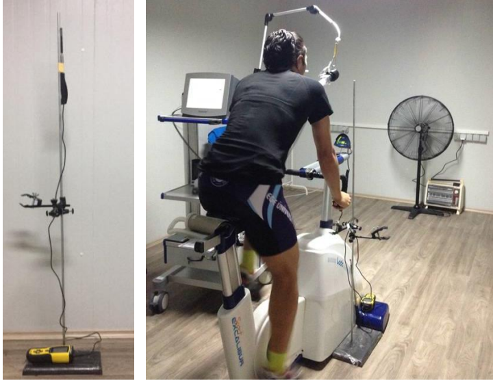
Şekil 5.13. Anemometre (a) ve aktivite sırasında anemometre ile yapılan ölçümler (b)
