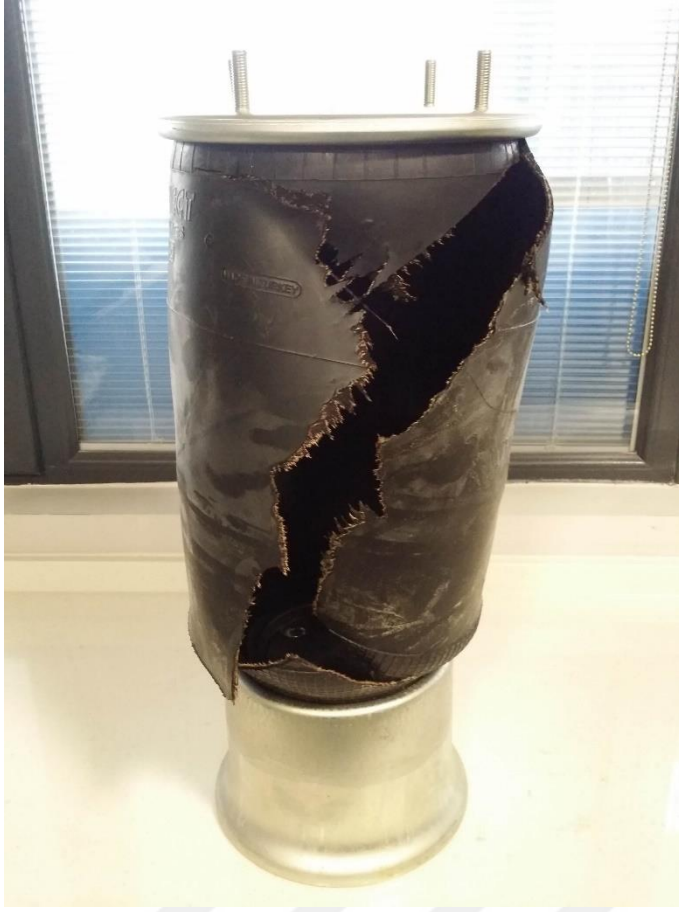
Resim 5.1. Patlatma testi uygulanmış körük
