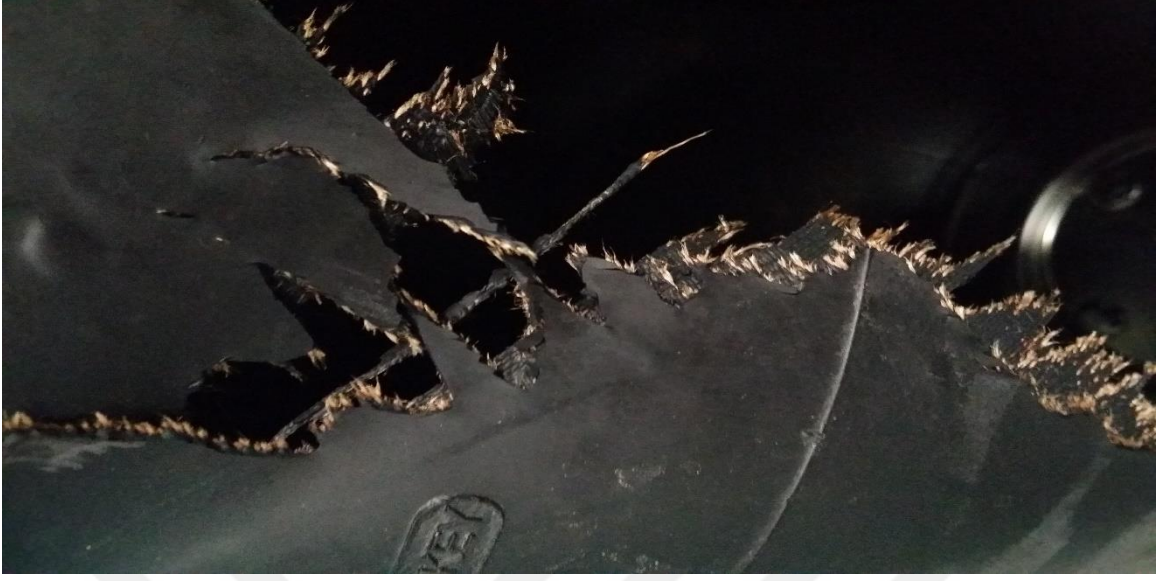
Resim 5.3. Patlatılmış körüğün detaylı resmi - 2
