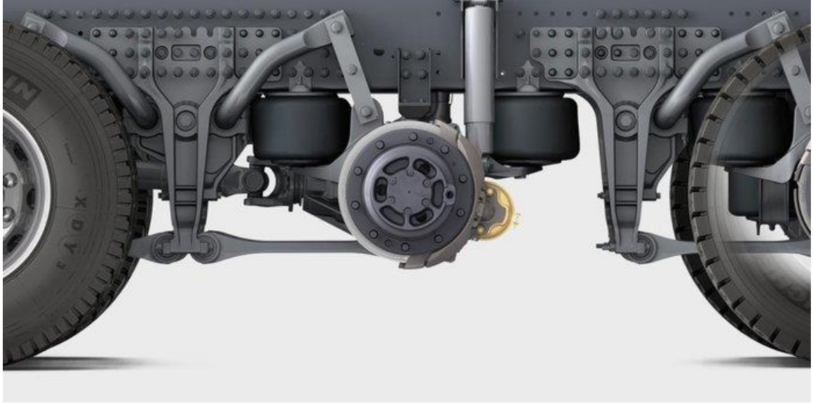
Resim 2.2. Hava süspansiyon körüklerinin araca monte edilmiş hali [5]
