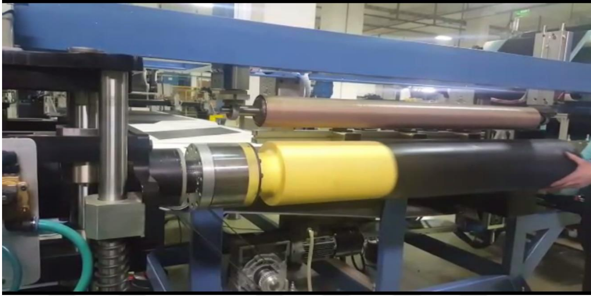
Resim 4.9. Otomatik makinede tamamlanmış yarı mamulün malafadan çıkarılması
