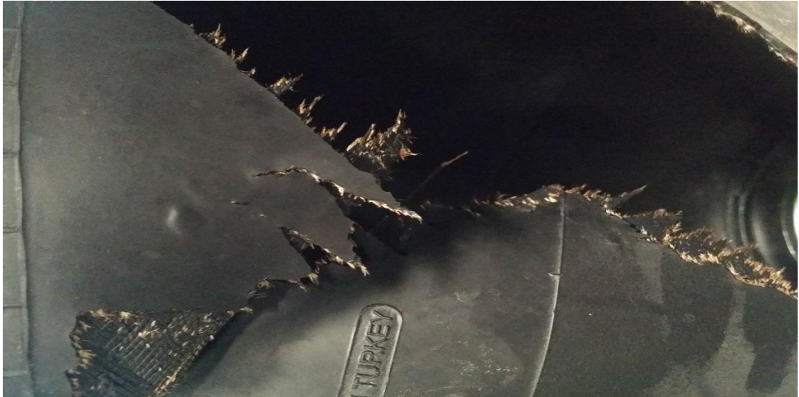
Resim 5.2. Patlatılmış körüğün detaylı resmi – 1
