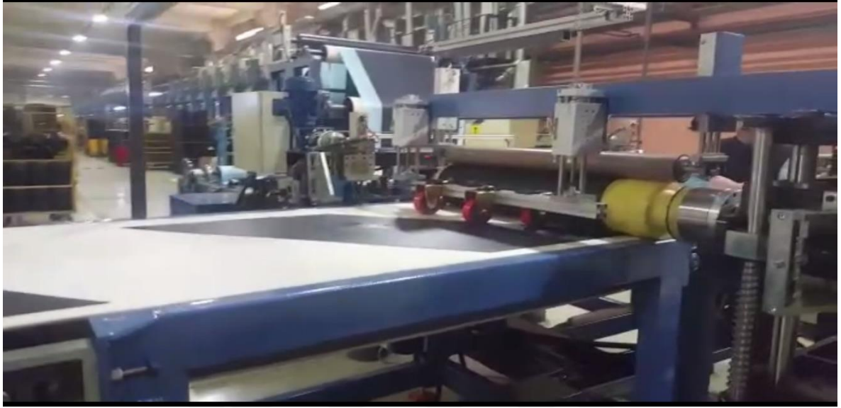
Resim 4.5. Otomatik makinede 1. kord bezinin iç kauçuğun üzerine sarılması
