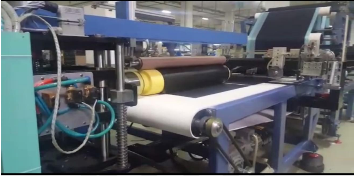
Resim 4.7 Otomatik makinede dıř kauçuęun 2. kord bezinin üzerine sarılması
