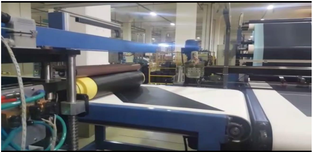
Resim 4.6. Otomatik makinede 2. kord bezinin 1. kord bezinin üzerine sarılması
