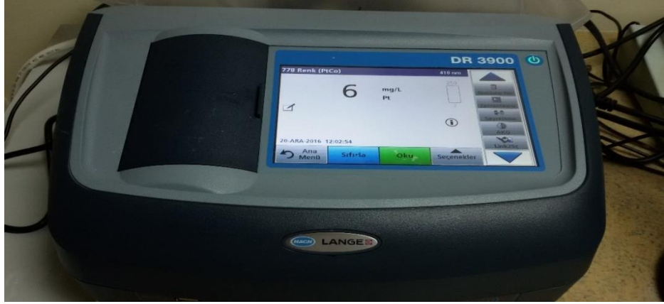
Şekil 3.4. Renk ölçümü için kullanılan spektrofotometre.
