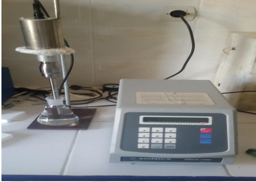
Şekil 3.3. Ultrases cihazı deney düzeneği.
