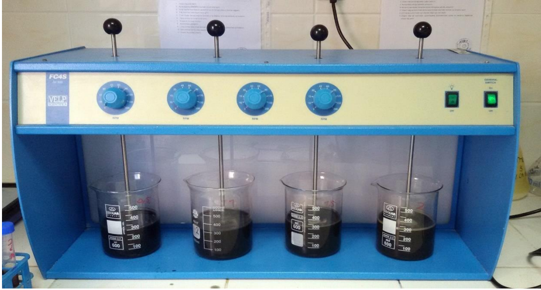
Şekil 3.1. Kimyasal Fenton Oksidasyon metodu deney düzeneği.
