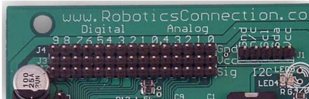
Şekil 3.3. Genel Amaçlı I2C I/O Hat Pin Çıkışları (RoboticsConnection,2010)
