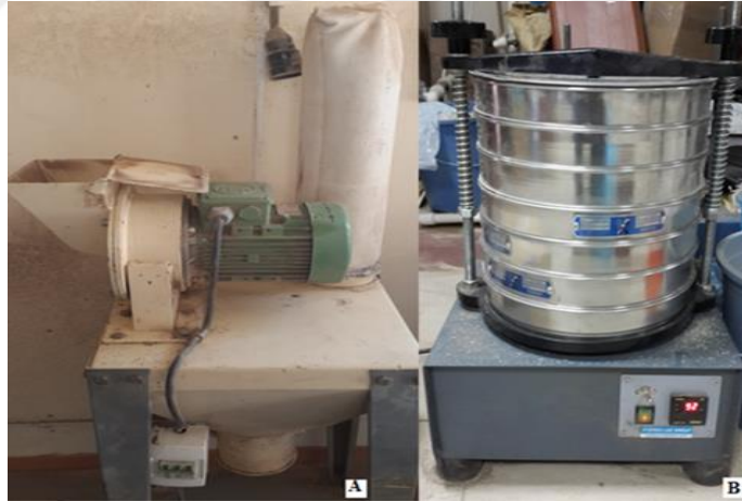
Şekil 3.2. Üretimde kullanılan Wiley tipi değirmen (A), sarsak elek (B).(Foto; Çavuş, 2017).
