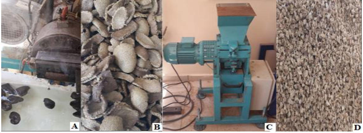
Şekil 3.6. Ekstruder eriyiğin suda soğutulması (A), elde edilen soğumuş karışım (B), kırma makinesi (C), üretilen pelletler (D), (Foto; Çavuş, 2017).
