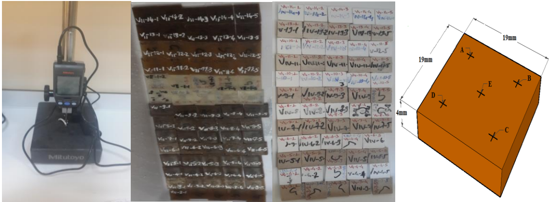
Şekil 3.14. Kalınlık artış oranının belirlenmesinde kullanılan deney numunesinin şekil ve boyutları ile numunelerin ölçmesinde kullanılan komparatör saati.
