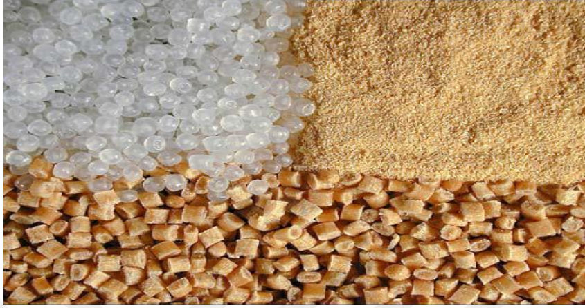
Şekil 1.1. Odun ve plastikler ile bunlardan elde edilen pelletler.
