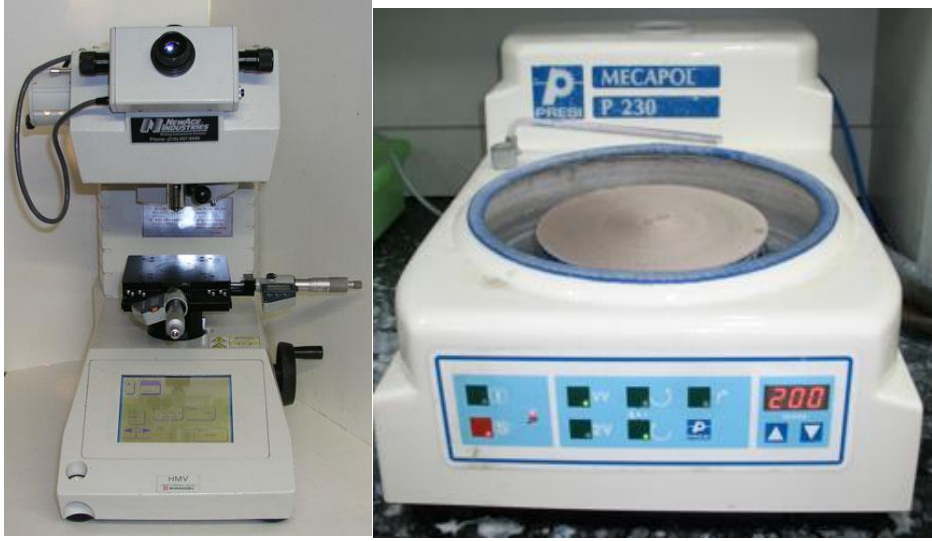
Resim 3.7. Vickers sertlik ucuna sahip, mikrosertlik test cihazı HMV – 700 (sol) örneklerin zımparalanmasında kullanılan Mecapol P 230 (sağ)
