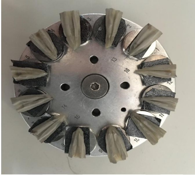
Resim 3.2. SEM deęerlendirmesi ncesinde metal plaka zerinde yerleřtirilen rnekler
