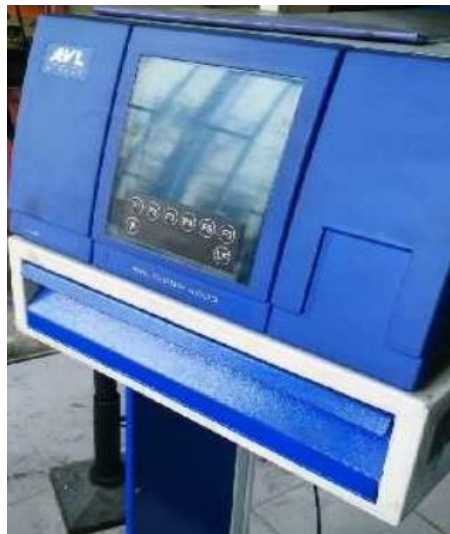
Resim 4.9 Avl 4000 DiSmoke egzoz emisyon cihazı (Maden 2016).
