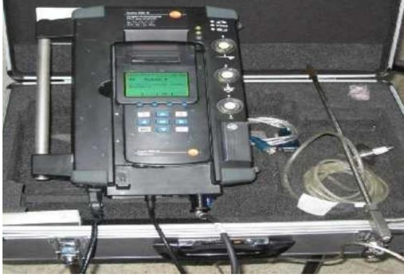
Resim 4.8 Testo 350-s marka egzoz emisyon cihazı.
