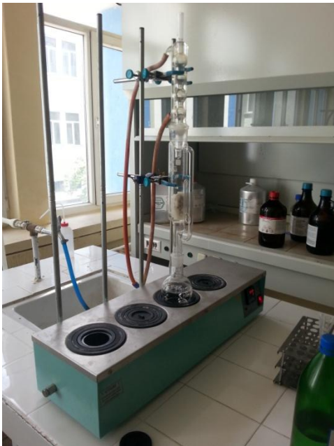
Şekil 3.2. Yağ miktarının belirlenmesinde kullanılan Soxhelet ekstraksiyon sistemi
